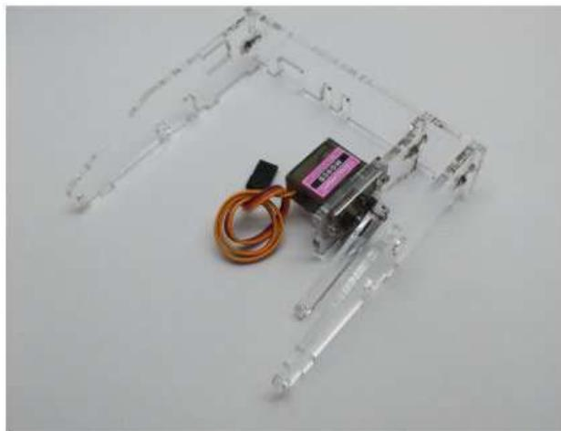
Befestigen Sie die Grundplatte mit M2,5x8 Maschinenschrauben und 3 mm Kunststoffabstandshaltern an der Grundplatte. Ziehen Sie die Schrauben nur locker an, damit sich die Platte noch etwas bewegen kann. Beachten Sie, dass die Schrauben in die Grundplatte eingeschraubt werden, Muttern sind nicht erforderlich.
