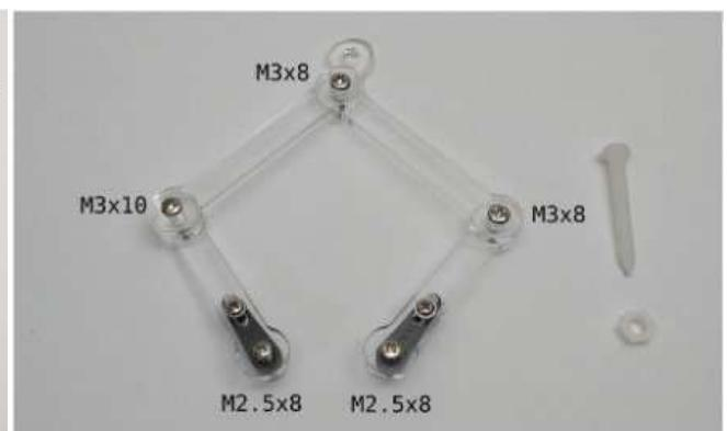
Montieren Sie die Arme für die „Stifthalterung“. Schrauben Sie Teil (J) mit einer M3x8-Maschinenschraube auf eines der Teile (I). Schrauben Sie anschließend Teil (K) mit einer M3x8-Maschinenschraube auf Teil (J). Zum Schluss schrauben Sie die andere Seite von Teil (K) mit einer M3x10-Maschinenschraube auf das zweite Teil (I), wobei sich die runde Acrylscheibe (L) dazwischen befindet.
